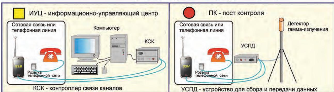
Рис. 7. Автоматизированная система контроля радиационной обстановки Томской области АСКРО ТО
